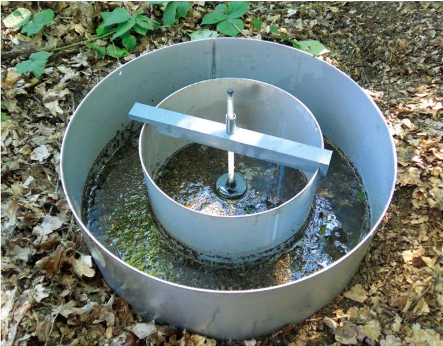
Abb. 2: Versuchsdurchführung Doppelring-Infiltrometer
