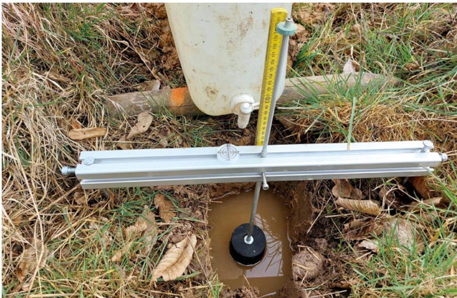
Abb. 1: Versuchsdurchführung kleine Testgrube (nach Mahabadi / Zunker) Quelle: Christian Oltmanns
