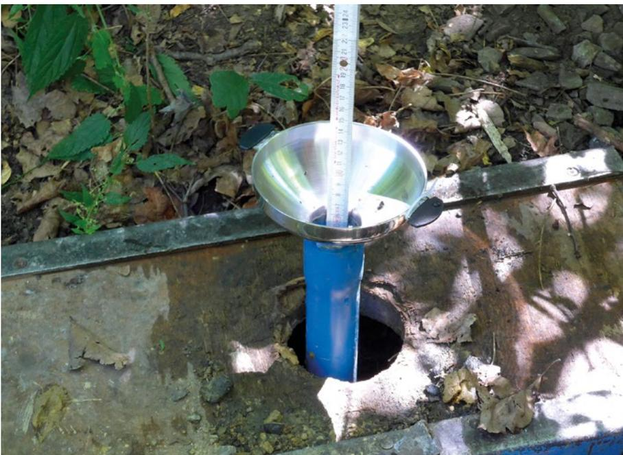
Abb. 3: Versuchsdurchführung Open-End-Test
