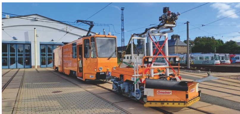
Kürzlich wurde auch auf Meter-Spur gearbeitet: Trimble MX) erfasste dabei das Straßenbahnnetz in Zwickau.
