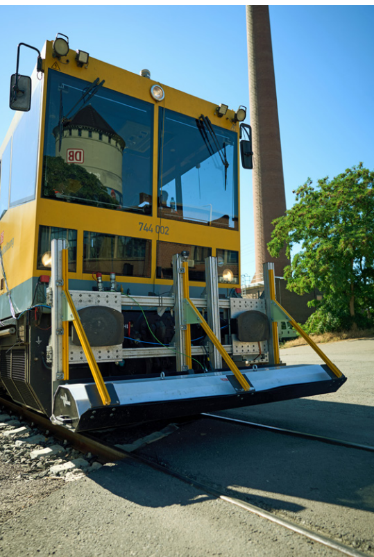
1: Anbau des Georadar-Arrays mit 28 Kanälen an einem Gleisarbeitsfahrzeug Quelle: Henry Fried
